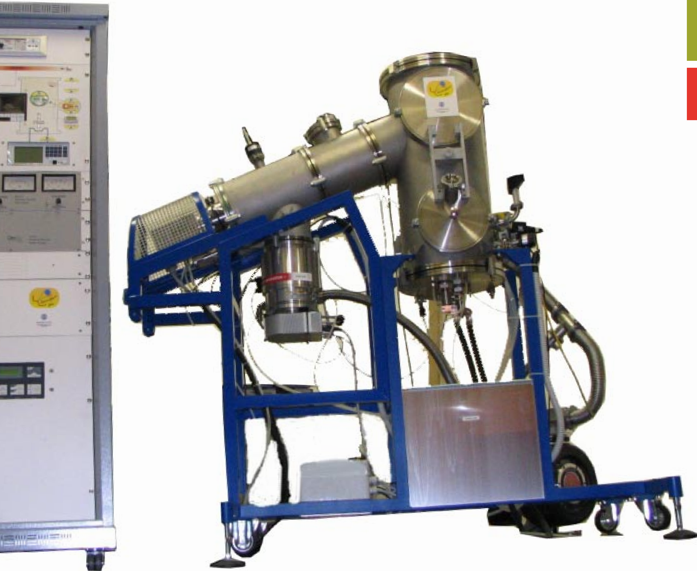
Industrial prototype of IBAD for the spheres coating with lubricating films Prototipo industriale di IBAD per il rivestimento di sfere con film lubrificanti
